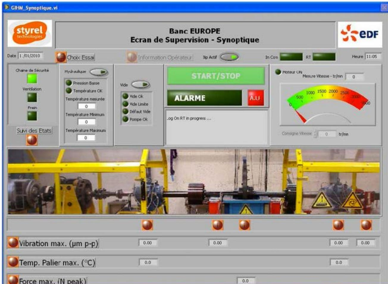
*Écran de supervision de l'installation permettant de lancer un essai et de visualiser le comportement sécuritaire du banc et de l'équipement en test*
